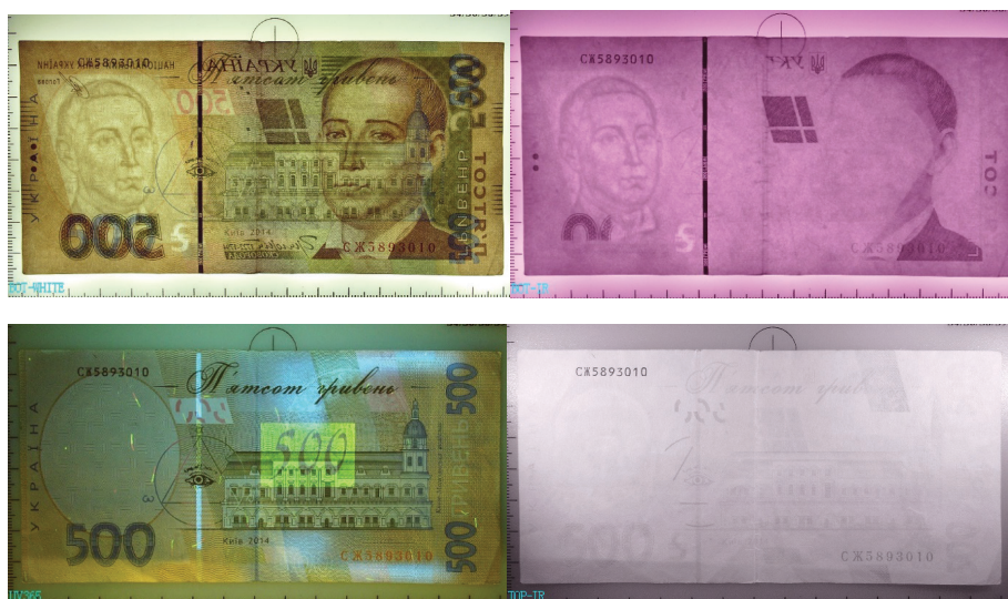
Рис. 6–9. Зображення банкноти номіналом 500 гривень зразка 2006 року виготовлені з використанням пристрою HS9P в автоматичному режимі
