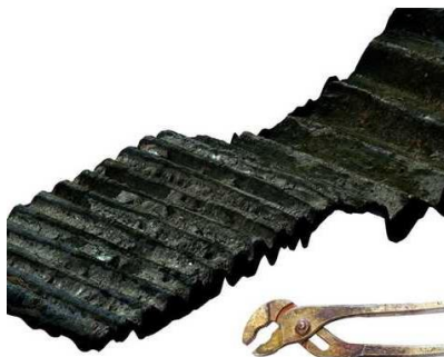
Рис. 2. 3D-модель робочої поверхні кліщів, отримана за допомогою системи ToolScan (зображення з сайту виробника).
