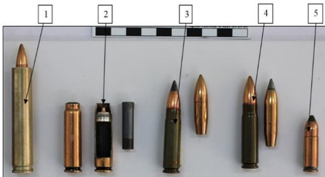
Рис. 4. Спеціальні патрони: 1 – СП-3; 2 – СП-4; 3 – СП-5 9x39 мм; 4 – СП-6 9x39 мм; 5 – СП-10 9x21 мм.
