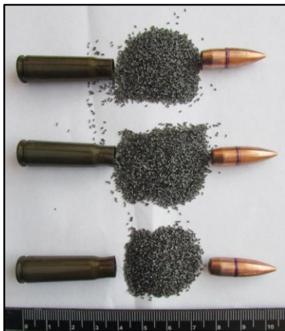
Рис. 6. 7,62-мм патрон УС зр. 1943 р. зі зменшеною швидкістю (інд. 57-Н-231У), призначений для стрільби з приладом безшумної та безполум'яної стрільби ПББС-1.
