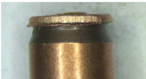
Рис. 9. Сліди деформації донньої частини гільзи, відстріляної з відновленого нейтралізованого пістолета.
