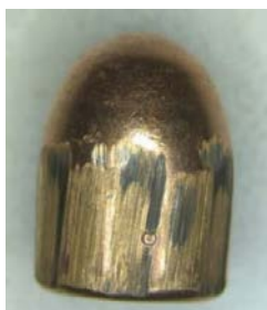
Рис. 14. Куля, відстріляна з саморобного ствола з меншим калібром, ніж калібр кулі.
