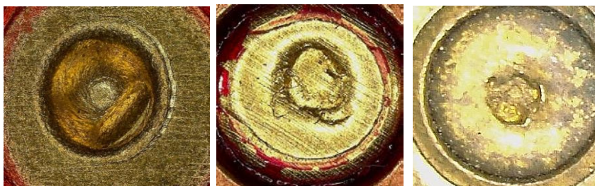
Рис. 2. Конструктивні відмінності відновленого ударника нейтралізованого пістолета Макарова (ліворуч) та штатного ударника аналогічної зброї (праворуч).
