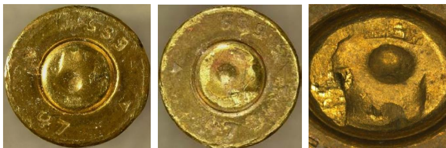
Рис. 6. Сліди зброї на гільзах, відстріляних з відновленої нейтралізованої зброї.
