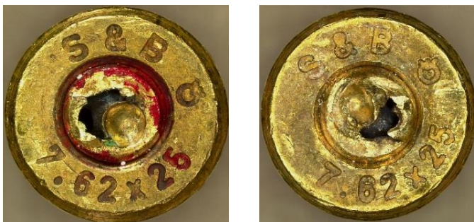
Рис. 8. Сліди розриву капсуля на гільзах відстріляних з відновленого пістя нейтралізації пістолета ТТ.
