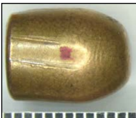
Рис. 15. Куля відстріляна з саморобного ствола з більшим калібром, ніж калібр кулі.
