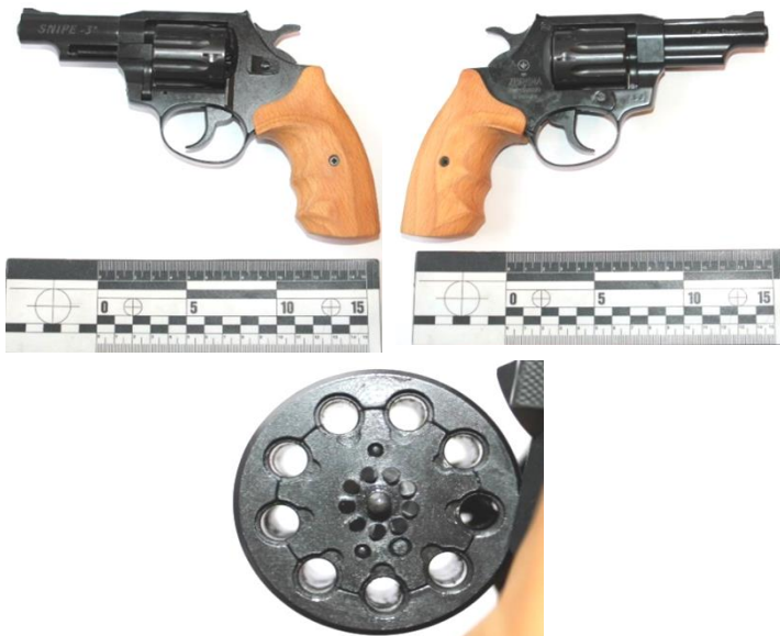
Рис. 2. Револьвер «Snipe - 3», призначений для стрільби патронами калібру 4-мм Флобера
