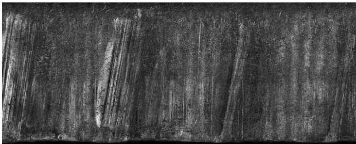
Рис. 6. Ведуча частина кулі патрона 9x19 мм, стріляної з 9-мм пістолета «Glock 17».
