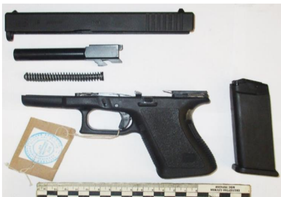
Рис. 1. 9,00-мм пістолет «Glock-17» другого покоління у частково демонтованому вигляді.
