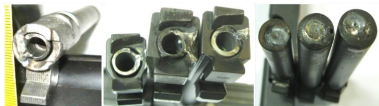
Зображення 2. Металеві елементи, зафіксовані у стволах зброї за допомогою зварювання.
