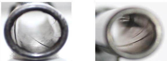
Зображення 5. Конструктивні відмінності каналу ствола саморобного виготовлення, встановленого на пістолет Макарова (ліворуч) та штатного ствола аналогічної зброї (праворуч).
