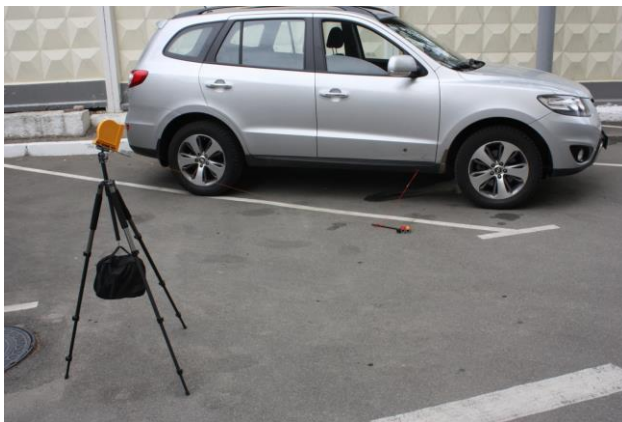
Рис. 1. Візування під час слідчого експерименту траєкторії підльоту снаряда, стріляного з гладкоствольної рушниці, до автомобіля (вертикальна площина)
