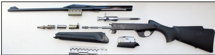
Рисунок 6. Карабін «Argo E Comfortech» після неповного розбирання.
