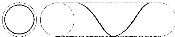
Рис. 1. Схематичне зображення лазерного маркування нанесеного у стволі гладкоствольної вогнепальної зброї:
