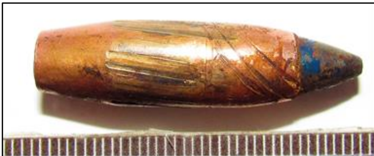
Рис. 10. Сліди полів нарізів на кулі патрону СП-6.
