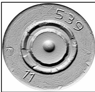
Рис. 8. Сліди від частин зброї на гільзі патрону СП-4 калібру 7,62x41 мм.
