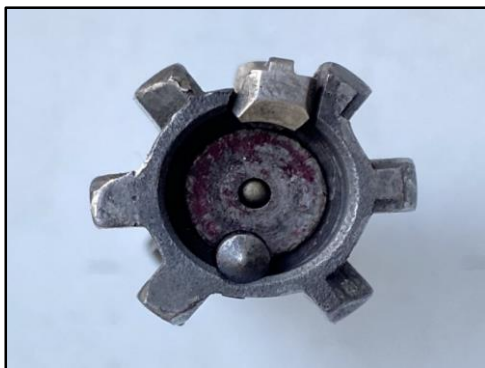
Рис. 2. Чашка затвору гвинтівки спеціальної снайперської «Вінторез».
